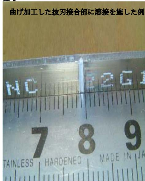
曲げ加工した抜刃接合部に溶接を施した例
